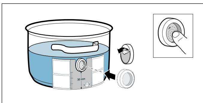
3. Прижать всю поверхность силиконовой накладки, также и изнутри.
