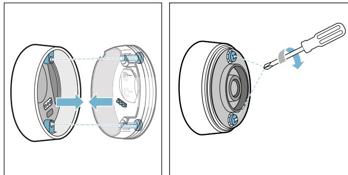
4. Установите силиконовую крышку обратно на нижнюю часть корпуса датчика температуры.
