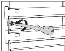
**1** Открутите винт с помощью отвертки.
