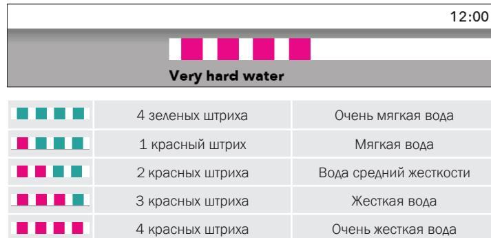
Опустите тест-полоску (прилагается в комплекте) в воду на 1 секунду. Через одну минуту введите результат (количество штрихов на тест-полоске) в прибор. Поверните ПЕРЕКЛЮЧАТЕЛЬ.
