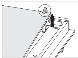
**1** Немного приподнимите фиксаторы с левой и правой стороны дверцы (символ 1 на фиксаторе) и потяните в стороны от стекла (символ 2 на фиксаторе).
