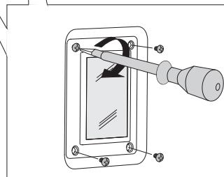
**1** Открутите четыре винта на крышке. Снимите крышку.
