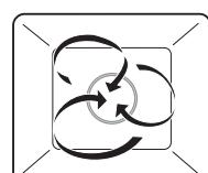
Воздух в камере прогревается нагревательным элементом, расположенным за задней стенкой камеры, и равномерно циркулирует. За счет регулируемой по времени функции открывания дверцы выступающая из приготовляемого блюда влага обильно выводится через равные промежутки времени. Приготовляемое блюдо высыхает медленно.
