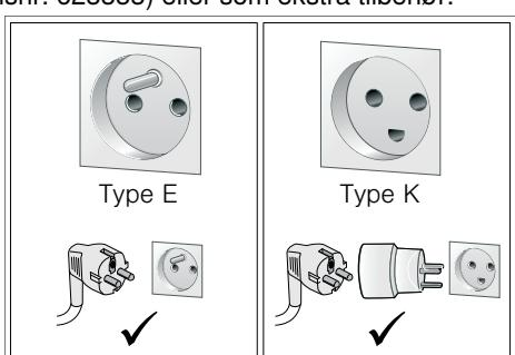
Hvis stikket ikke er tilgængeligt efter installationen, skal der i en fast elektrisk installation være monteret en afbryderanordning på faserne i henhold til installationsbestemmelserne.
