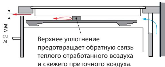
Верхнее уплотнение предотвращает обратную связь теплого отработанного воздуха и свежего приточного воздуха.
