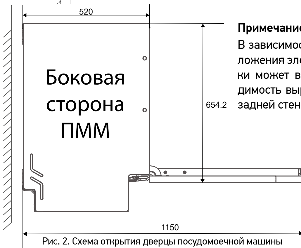
Рис. 1. Размеры посудомоечной машины и модуля для встраивания
