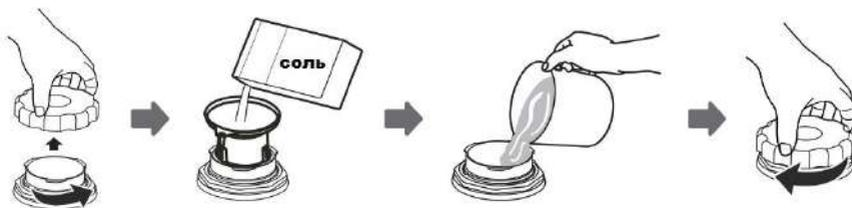
1. Снимите нижнюю корзину и открутите крышку резервуара.
