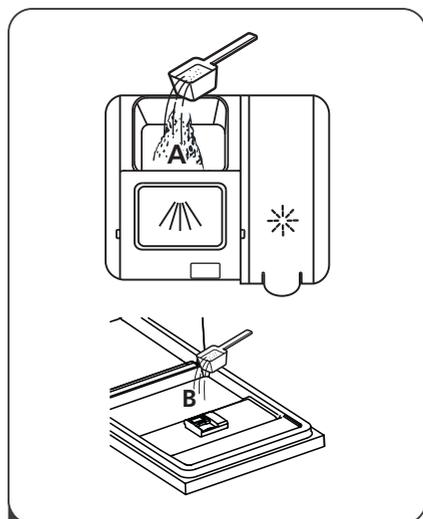
**2** Для основного цикла мойки добавьте моющее средство в отсек (А). Для лучшего результата мойки, особенно если посуда очень грязная, можно добавить небольшое количество моющего средства на дверь (В). Дополнительное моющее средство будет использоваться для предварительной мойки.
