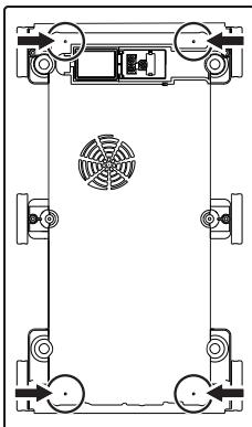
2. Для правильного крепления варочной панели к конструкции ввинтите крепежные кронштейны (A) в отверстия, намеченные ранее удаленными винтами.
