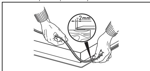
**!** Не закрепляйте варочную панель при помощи силикона, так как это приведет к повреждению варочной панели в случае ее демонтажа.
