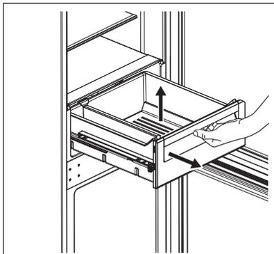
2. При закрытии дверцы задвиньте направляющие внутрь корпуса во избежание повреждения прибора.
