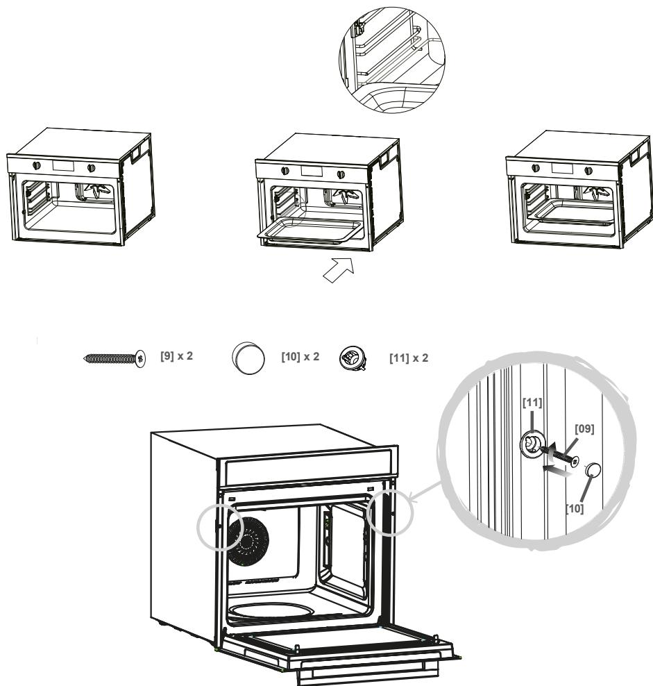
Sobald der Backofen im Küchenmodul platziert ist, befestigen Sie ihn mit Hilfe der beiden Löcher im Gerätegehäuse und den Befestigungselementen [09], [10] und [11].
