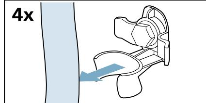
2. Отверните и снимите все винты четырёх транспортировочных креплений.
