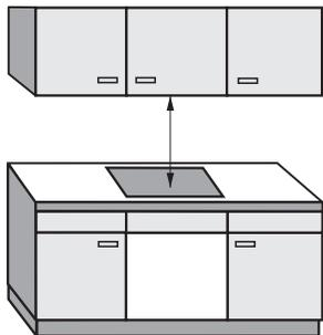
Необходимо соблюдать указанное производителем вытяжки безопасное расстояние между прибором и расположенной сверху вытяжкой. Если указания производителя вытяжки отсутствуют или над прибором устанавливаются навесные полки из легко воспламеняющихся материалов, то необходимо соблюдать безопасное расстояние мин. 760 мм.
