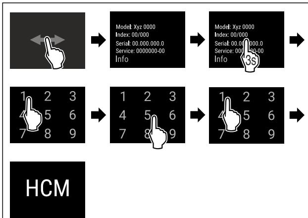
Fig. 5 Доступ при помощи числового кода **151**
