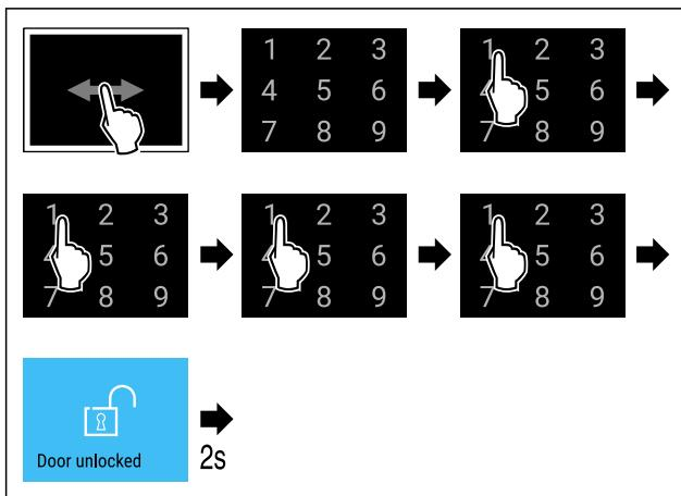
Fig. 71 Разблокировка двери при помощи кода двери
