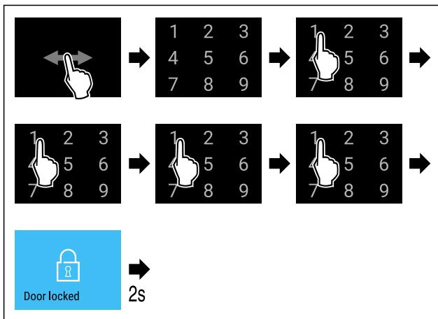
Fig. 68 Блокировка двери при помощи кода двери
