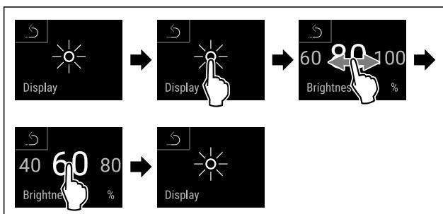
Fig. 49 Примерное изображение: переключение с 80 % на 60 %.
